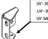
1/4" - 20 X 3/4" Hex Cap Bolt 2 1/4" - 20 Nyloc Nut 2 1/4" SAE Washer 4
